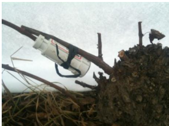
Figure 2 : Disposition des enregistreurs de température fixés à un sarment à environ 25 cm du sol, sous les protections.
